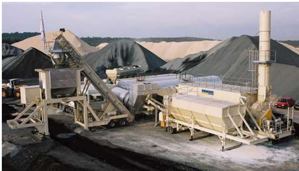
Illustration n° 4 : Photographie d'un poste d'enrobage de type TSM21
